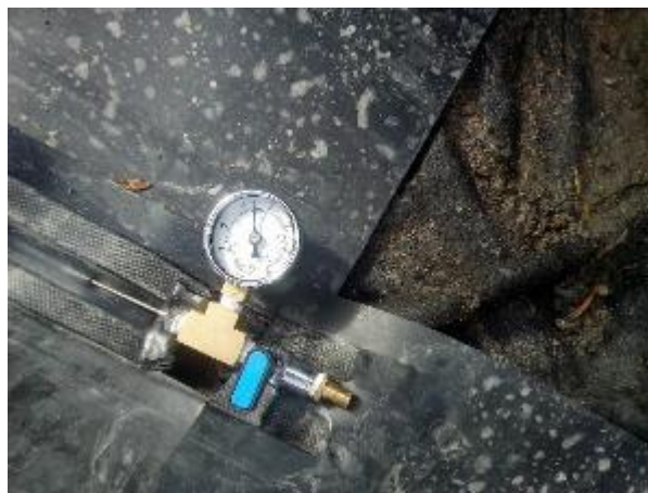
Prueba de canal de aire en soldaduras por cuña (sin observación)
