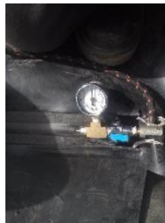
Prueba de canal de aire en soldaduras por cuña (sin observación)
