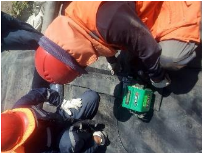
Prueba de partida con cuña, ensayo de corte y desgarre (sin observación)
