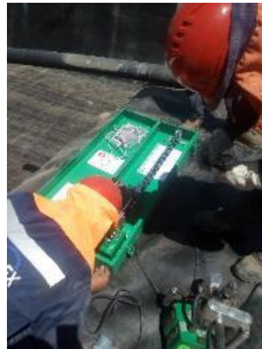
Prueba de partida con cuña, ensayo de corte y desgarre (sin observación)
